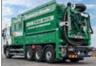
ESCAVATORE A RISUCCHIO "RHINO"
